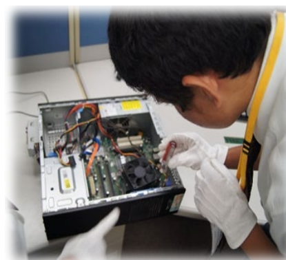
パソコン解体・組み立て
